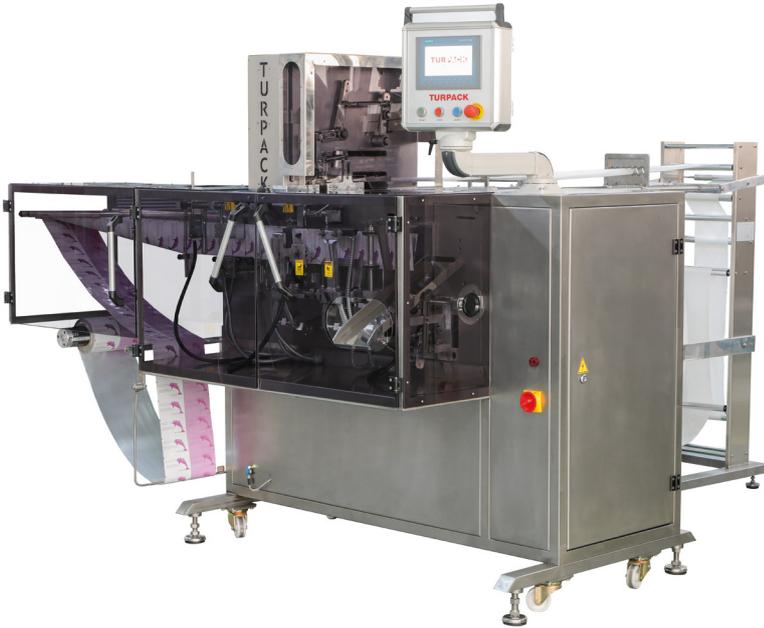
La machine à lingettes humides à sachet unique est utilisée pour emballer des mouchoirs humides à usage unique dans un sachet scellé à 4 côtés. Il peut effectuer le travail de pliage, de coupage, de formation de sachet, d'ajout d'eau, de tranchage, d'impression de codes et de comptage. Construction entièrement en acier inoxydable.
